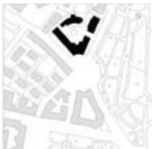
Il complesso, centrato sulla bisettrice dell'angolo formato dalle due strade di tangenza, è formato da due distinti bracci divergenti e un blocco, dal profilo arcuato, che forma il terzo lato di una corte interna. Il raccordo in angolo è risolto con due alti torrioni a base circolare che, ponendo in tensione percettiva le cortine dei fronti sulle opposte vie, fungono da baluardi e inquadrano il profondo portale dell'ingresso principale.
