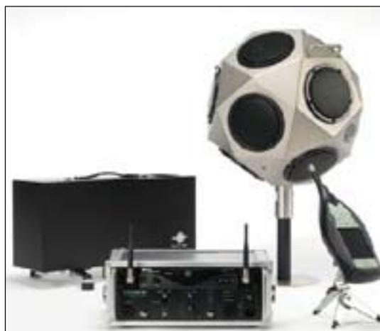
Figura 3 – Strumentazione per acustica edilizia
