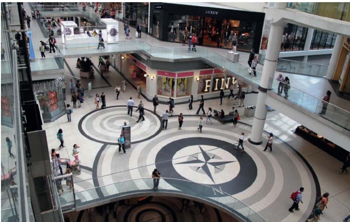
Pavimentazione di un centro commerciale realizzata con pietre sinterizzate
