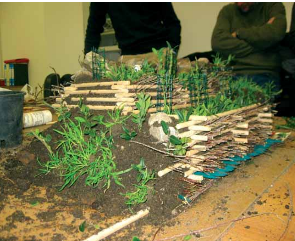
Il consolidamento con una scogliera rinverdita e una gabbionata rinverdita
